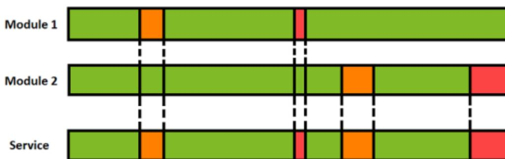
В данном примере мы можем видеть схему расчета конечного обслуживания в зависимости от запланированных отключений (оранжевый) и критических состояний (красный) модулей, от которых зависит конечное состояние обслуживания для расчета его SLA.
