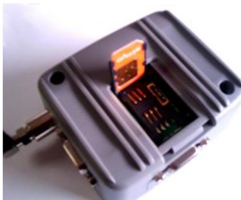
電源を接続し、SMS ゲートウェイデバイスに USB ケーブルを接続します。
