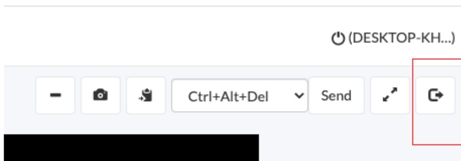
Una vez conectado, existe una barra de botones flotantes en la parte superior de la pantalla remota. Estas opciones permiten minimizar la barra de botones, obtener una captura de pantalla, acceder al portapapeles remoto y permitir copiar/pegar en remoto, enviar una combinación de teclas (CTRL-ALT-DEL y otras), o poner el modo de pantalla completo.
