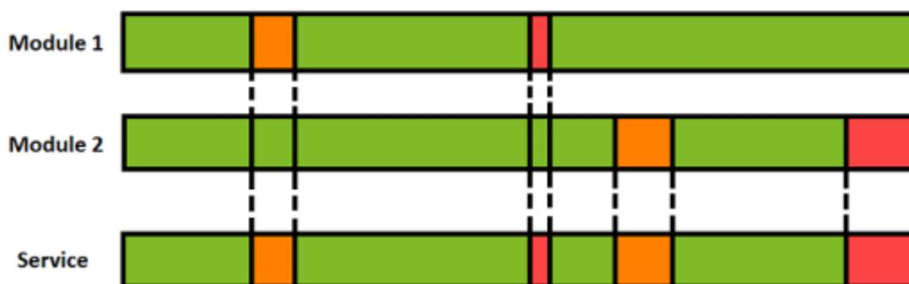
Dans cet exemple on peut voir un schéma du calcul final du service en fonction des arrêts prévus (orange) et des états critiques (rouge) des modules dont dépend l'état du service final pour son calcul SLA.
